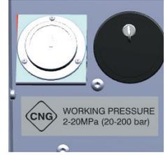
Kraftstoff-Kennzeichnungsetikett auf CNG-Behältern
