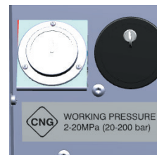
Etykieta identyfikacyjna paliwa na zbiornikach CNG
