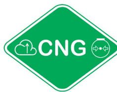
Etykieta identyfikacyjna paliwa na zbiornikach CNG
